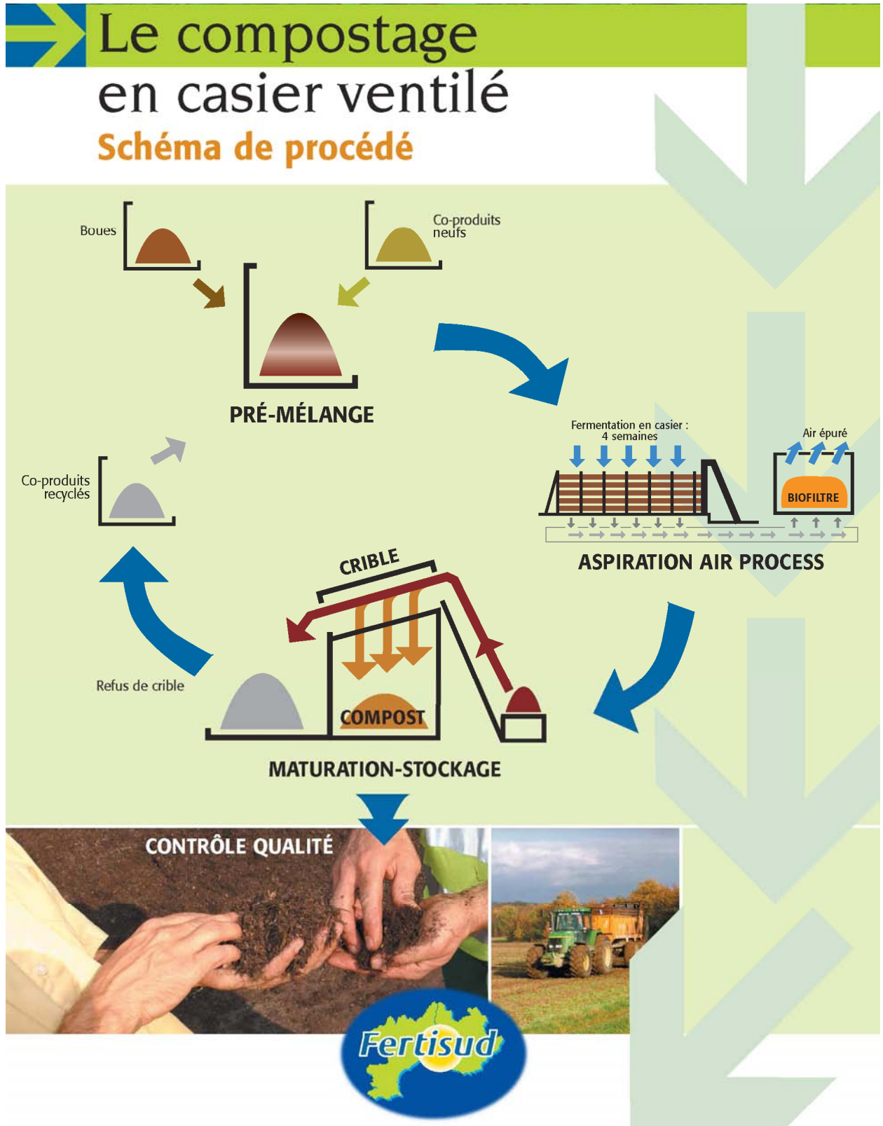
Figure 26 : Procédé de compostage en ventilation forcée
