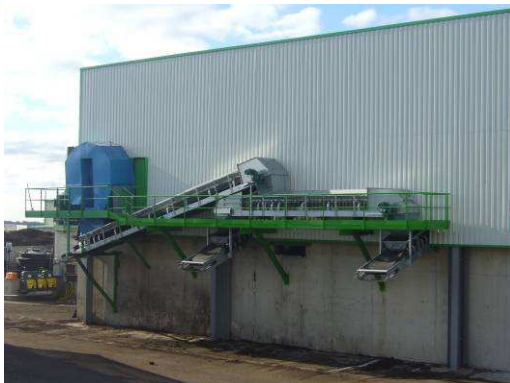
Figure 25 : Traitement des poussières en zone criblage
